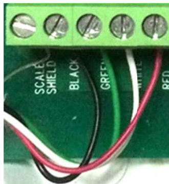
Figure 1: Connexions du module de pesée au module d'enregistrement.
